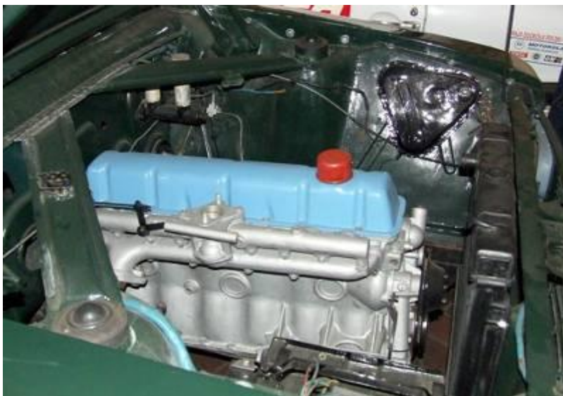
36. Silnik Warszawy 210, sześciocylindrowy o pojemności 2,51 l, o mocy 85 KM przy 4200 obr./min
