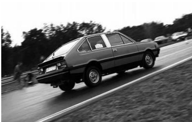
80. Wersje cywilne 3-drzwiowego Poloneza miały boczne tylne szybki uchylne
