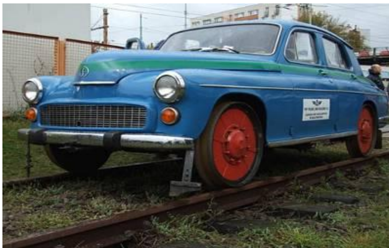
19. Tę Warszawę przerobiono na dreżynę. Umożliwiała szybki przejazd (do 100 km/h) po torach na wybrane miejsce, ale także jazdę po drogach bitych
